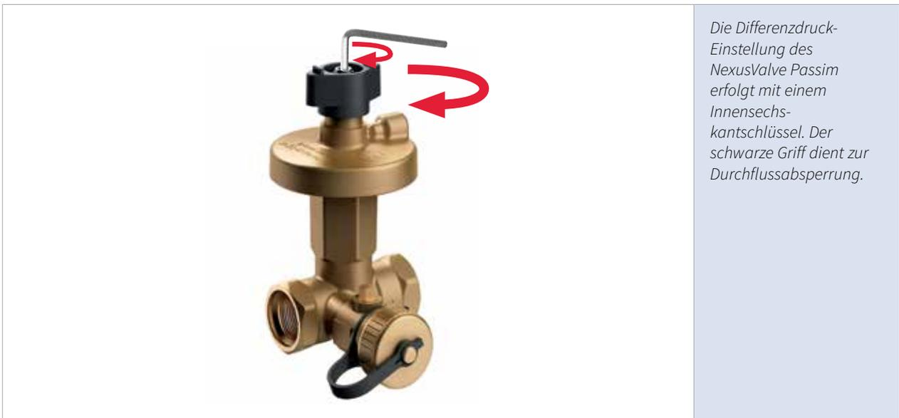
Mit einem Innensechskantschlüssel kann eine Einstellung innerhalb des Differenzdruckbereiches vorgenommen werden. Mit dem schwarzen Griff wird der Durchfluss abgesperrt.
