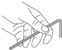
Um das NexusValve Passim anders einzustellen, den Innensechskantschlüssel gegen den Uhrzeigersinn drehen, bis der Endpunkt erreicht und die Feder völlig entspannt ist. Ab diesem Punkt den Innensechskantschlüssel im Uhrzeigersinn um die Anzahl an Drehungen drehen, die in den obigen Tabellen der erforderlichen  $\Delta P$ -Einstellung entspricht. Die Differenzdruckeinstellung erfolgt mit einem 4-mm-Innensechskantschlüssel.
