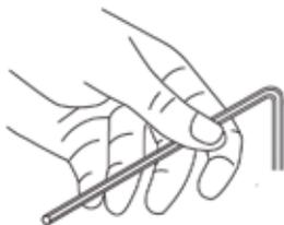
Um das NexusValve Passim anders einzustellen, den Innensechskantschlüssel gegen den Uhrzeigersinn drehen, bis der Endpunkt erreicht und die Feder völlig entspannt ist. Ab diesem Punkt den Innensechskantschlüssel im Uhrzeigersinn um die Anzahl an Drehungen drehen, die in den obigen Tabellen der erforderlichen  $\Delta P$ -Einstellung entspricht. Die Differenzdruckeinstellung erfolgt mit einem 4-mm-Innensechskantschlüssel.
