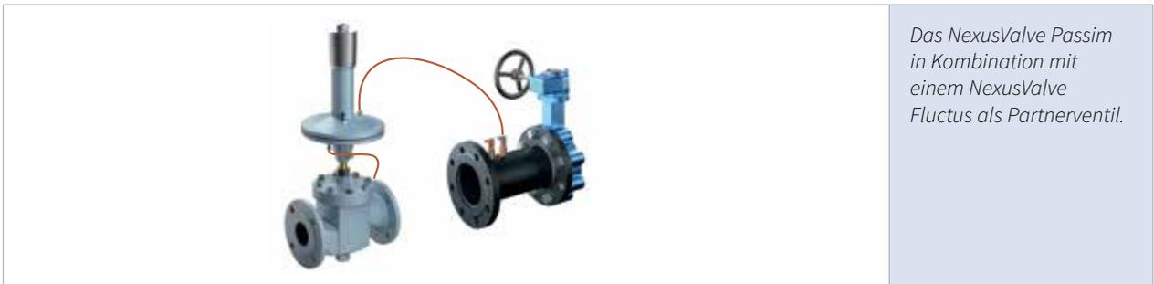
Wenn das NexusValve Fluctus als Partnerventil benutzt wird und im Vorlauf installiert ist, wird es im Systemkreis durch das NexusValve Passim geregelt. In diesem Fall muss der Druckabfall am NexusValve Fluctus-Ventil zum Druckabfall im geregelten Kreis addiert und bei der Einstellung des NexusValve Passim-Ventils berücksichtigt werden.
