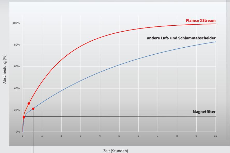
● 100% (100 Gramm) des Magnetits sind vollständig getrennt. Ab diesem Moment werden nur noch Eisenpartikel getrennt.
