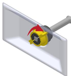
Zur Befestigung des Schilderhalters einfach die Mutter von Hand um 90° drehen.
