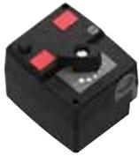
Per il montaggio diretto sul miscelatore. Con alimentatore a spina da 230V~, 50 Hz Durata 140 s / 90°, senso di rotazione reversibile; 6 Nm. 4 Campi di regolazione 0 ... 95 °C, impostazione digitale del valore nominale e visualizzazione temperatura, funzionamento manuale di emergenza, indicazione della posizione, sensore di temperatura  $\varnothing 6 \times 25$  mm con cavo da 1m, cablatura fissa.
