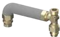
Tubo corrugato preisolato e preformato con 2 dadi di raccordo da ¾"; pezzo a T in ottone inclusi i collegamenti alle stazioni solari da ¾" M per la continuazione in loco delle linee di collegamento; un tappo da ¾".
