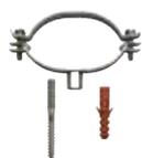
Set di fascette ovali costituito da una fascetta ovale per il fissaggio del tubo corrugato in acciaio inox inoflex in isolamento doppio DN 16 e DN 20 inclusa la vite prigioniera M 8 x 80 e tasselli.
