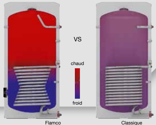
Stratification du chauffage (à mi-chemin) dans des chauffe-eau et des vases tampons Flamco par rapport à des chauffe-eau et des vases tampons classiques.
