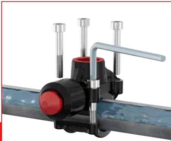
Décaper le tube correctement. Visser le Flamco T-plus à l'aide des 4 vis. Serrer alternativement les vis. Veuillez respecter le couple de serrage indiqué dans la notice d'utilisation.
