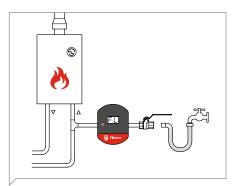
Flexcon PA avec app. Le monteur raccorde l'appareil à l'installation de chauffage central. Si nécessaire, le client fait lui-même l'appoint de l'installation, en raccordant un tuyau à l'installation.
