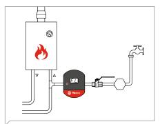
Flexcon PA avec app avec raccordement permanent à une conduite d'eau. Le monteur installe l'appareil avec un tuyau d'eau, une vanne d'arrêt et une protection antiretour. Le client doit juste ouvrir la vanne pour faire l'appoint.
