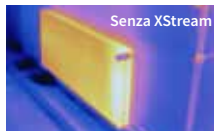
Radiatore con blocco dell'aria in alto e blocco delle impurità in basso
