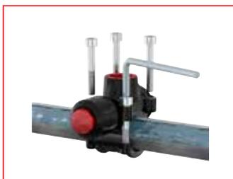
Den T-plus mit vier Schrauben am Rohr befestigen. Bei Modellen ab 1½" werden ClickIn-Muttern mitgeliefert, bei denen die Schraube erst eingeschoben und dann angezogen wird.
