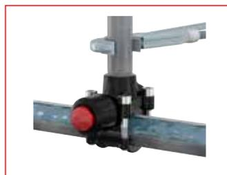
Die Schrauben kreuzweise festziehen. Achten Sie auf das in der Montageanleitung angegebene Anzugsdrehmoment. Die Abzweigung anschließen. Bei der Aktivierung des T-plus darf sich kein Wasser in der Abzweigung befinden!
