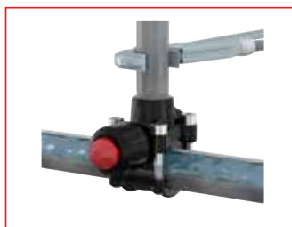
Keerake poldid kinni ristjärjestuses. Kasutage juhendis esitatud pingutuskrivi pöördemomenti. Ühendage toru. Veenduge, et T-plusi aktiveerimisel poleks haru vett.
