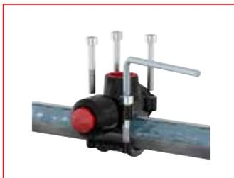
Posez le T-plus sur le tube et fixez-le avec quatre boulons. Les modèles à partir de 1 1/2" sont fournis avec des écrous à encliqueter; le boulon est encliqueté, puis vissé.
