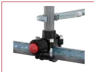
Serrare i bulloni a croce. Utilizzare la coppia di serraggio specificata nel manuale di istruzioni. Collegare la derivazione. Accertarsi che non vi sia acqua nella derivazione quando viene attivato il T-plus.
