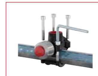
Aseta T-plus putkeen ja kiinnitä se neljällä pultilla paikalleen. Liittimissä alkaen koosta 1½" on click in -mutterit; pultti napsautetaan paikalleen ja kiristetään sen jälkeen kiinni.
