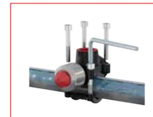
Posez le T-plus sur le tube et fixez-le avec quatre boulons. Les modèles à partir de 1½" sont fournis avec des écrous à encliqueter; le boulon est encliqueté, puis vissé.
