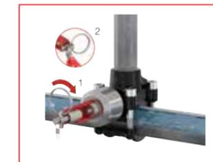
Vissez le déclencheur sur le T-plus. Positionnez la bague dans la direction la plus confortable pour la tirer (1). Coupez le plomb (2).
