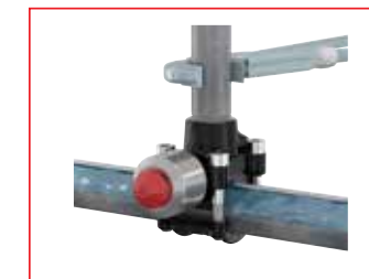
De bouten kruislings vast aandraaien. Let op het in de gebruiksaanwijzing vermelde aanhaalmoment. De aftakking aansluiten. Er mag tijdens het activeren van de T-plus geen water in de aftakking zitten!
