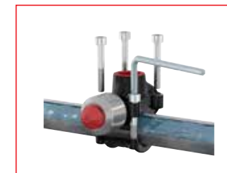
De T-plus op de buis bevestigen en met vier bouten vastzetten. Bij modellen vanaf 1½" zijn click-in moeren meegeleverd waar de bout het eerste deel kan worden ingedrukt alvorens aan te draaien.
