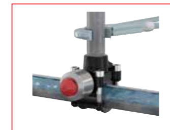
Dra åt dem korsvis. Använd det åtdragningsmoment som står i instruktionsboken. Anslut påsticket. Se till att det inte finns vatten i grenröret när T-plus aktiveras.
