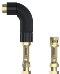
Die Sicherheitsbaugruppe verhindert im Falle von Störungen einen unzulässigen Temperaturanstieg im Niedertemperaturkreis. Beim Überschreiten der am Temperaturwächter eingestellten Temperatur schließt das im Vorlauf eingebundene Ventil den Heizwasserzutritt vom Heizkreis.
