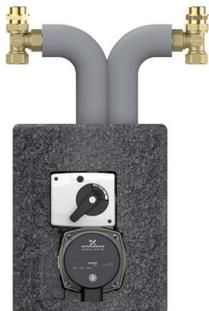
TKM-Kompaktblock aus Messing mit integriertem Primärbypass, Mischer mit einstellbarem Bypass und aufgesetztem Stellmotor, Pumpe mit Anschlusskabel, Tauchhülse für Vorlauffühler, Entlüftungsstopfen, Anschluss-Set für die Montage unter dem Wandkessel bestehend aus zwei T-Stücken sowie zwei flexiblen Verbindungen aus Edelstahl, Dichtungssatz, EPP-Isolierung, komplett vormontiert und auf Dichtheit geprüft.
