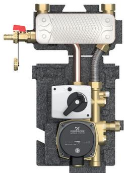
Kompaktblock aus Messing, Mischer mit einstellbarem Bypass und aufgesetztem Stellmotor, Pumpe mit Kabel, Kompaktwärmetauscher, Tauchhülse für Vorlauffühler, Entlüftungsstopfen, Wandhalterung, EPP-Isolierung, KFE-Hahn zur Entlüftung, 3/4" AG Anschlussmöglichkeit für Ausdehnungsgefäß, Anschluss-Set für die Montage unter dem Wandkessel bestehend aus zwei T-Stücken sowie zwei flexiblen Verbindungen aus Edelstahl.
