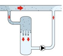
Schmutzpartikel, die größer als die Maschenweite sind, nicht wieder zurück zum Hauptfluss gelangen. Dies führt nicht zu einem höheren Widerstand, weil der Filter nicht direkt im Hauptfluss installiert ist. Das fließende Wasser wird nicht mehr gereinigt, sobald der Filter komplett
