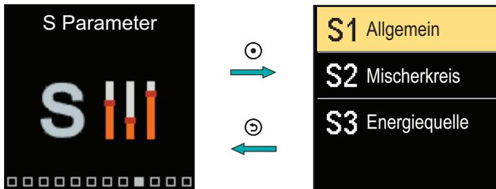
Navigieren Sie mit den Tasten ⊖ und ⊕ durch das Menü. Wenn Sie mit der ⊕ Taste die angeforderte Parametergruppe auswählen, wird eine Anzeige geöffnet, in der der erste Parameter in der Gruppe beschrieben wird.
