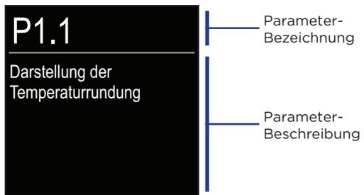
Navigieren Sie mit den Tasten  $\ominus$  und  $\oplus$  durch die Parameter in der ausgewählten Gruppe. Der Parameter, den Sie ändern möchten, wird durch Drücken der  $\odot$  Taste ausgewählt. Der Parametereinstellungsbildschirm, der die Form eines Menüs oder eines Schiebereglers haben kann, wird geöffnet.
