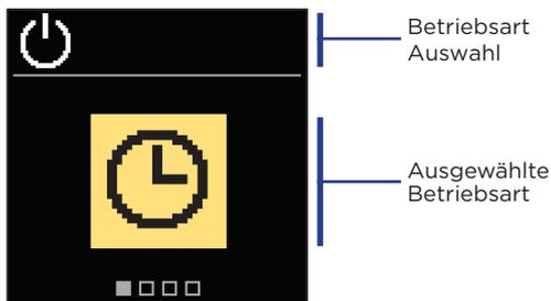
Verwenden Sie die Tasten  $\ominus$  und  $\oplus$ , um den gewünschten Betrieb auszuwählen. Die Einstellung verlässt man mit dem Drücken der Taste  $\odot$  oder  $\odot$ .
