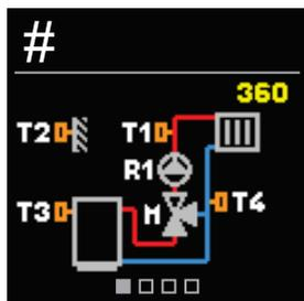
Sie können das Hydraulikschemata für den Reglerbetrieb auswählen. Verwenden Sie die Tasten ⊖ und ⊕, um zwischen den Schemata zu navigieren.
