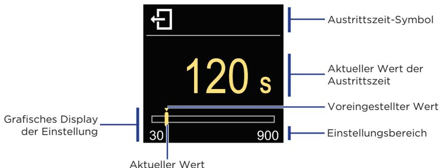
Mit den Tasten  $\ominus$  und  $\oplus$  können Sie die automatische Austrittszeit einstellen und sie mit der Taste  $\odot$  bestätigen. Beenden Sie die Einstellung mit der  $\odot$  Taste.
