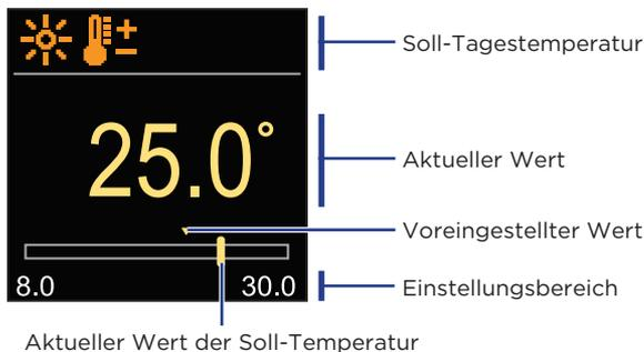
Verwenden Sie die Tasten  $\ominus$  und  $\oplus$ , um die Soll-Temperatur auszuwählen, und bestätigen sie mit der Taste  $\odot$ . Beenden Sie die Einstellung mit der  $\odot$  Taste.
