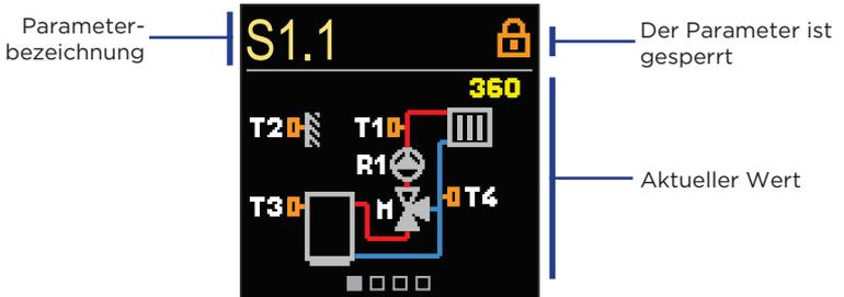
Navigieren Sie mit den Tasten  $\ominus$  und  $\oplus$  durch die Parameter in der ausgewählten Gruppe. Der Parameter, den Sie ändern möchten, wird durch Drücken der  $\odot$  Taste ausgewählt.
