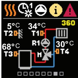
Hydraulikschema mit Bildschirm zeigt die gemessenen Temperaturen
