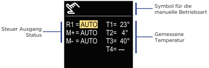
Mit den Tasten  $\ominus$  und  $\oplus$  können Sie zwischen den einzelnen Ausgängen R1, M + oder M- wechseln und mit der Taste  $\odot$  den Status AUTO, OFF oder ON auswählen. Die Einstellung verlässt man mit dem Drücken der Taste  $\odot$ .
