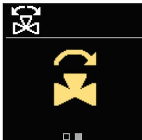
Sie können die Öffnungsrichtung des Mischventils auswählen. Verwenden Sie die Tasten ⊖ und ⊕, um zwischen den Richtungen zu navigieren.
