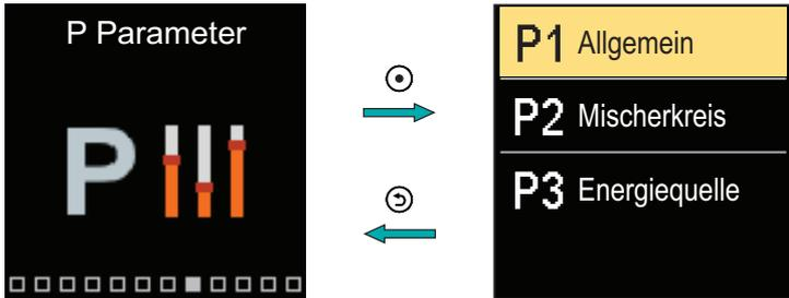
Navigieren Sie mit den Tasten  $\ominus$  und  $\oplus$  durch das Menü. Wenn Sie mit der Taste  $\odot$  die angeforderte Parametergruppe auswählen, wird eine Anzeige geöffnet, in der der erste Parameter in der Gruppe beschrieben wird.
