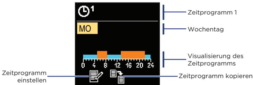
Mit den Tasten  $\ominus$  und  $\oplus$  können Sie den Tag auswählen, für den Sie das Zeitprogramm bearbeiten oder kopieren möchten, und ihn mit der Taste  $\odot$  bestätigen. Wählen Sie nun mit den Tasten  $\ominus$  und  $\oplus$  das Symbol aus, um das Zeitprogramm zu bearbeiten oder zu kopieren, und bestätigen Sie es mit der Taste  $\odot$ .
