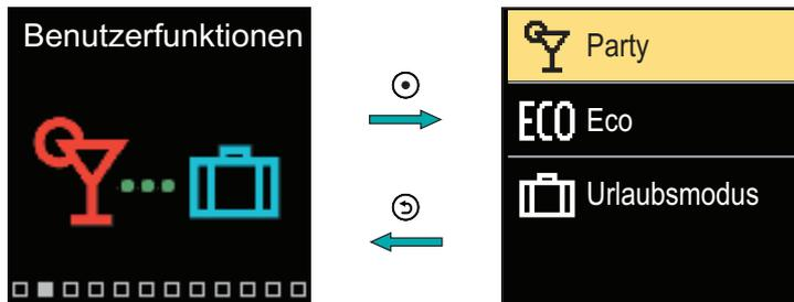
Navigieren Sie mit den Tasten  $\ominus$  und  $\oplus$  durch das Menü und bestätigen Sie Ihre Auswahl mit der Taste  $\odot$ . Der Bildschirm zum Einschalten und Einstellen der Benutzerfunktion wird geöffnet.
