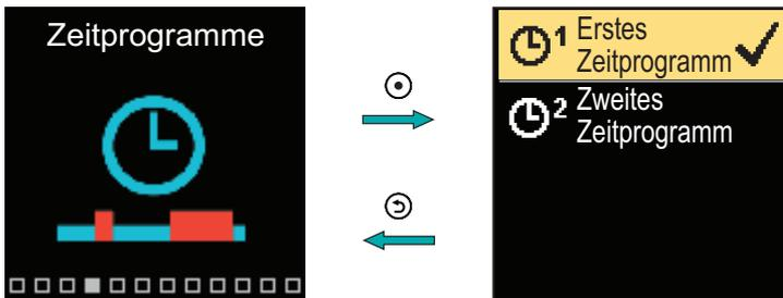
Navigieren Sie mit den Tasten  $\ominus$  und  $\oplus$  durch das Menü. Mit der Taste  $\odot$  können Sie das Zeitprogramm für den Betrieb auswählen und mit der Taste  $\odot$  die Einstellung des ausgewählten Zeitprogramms eingeben.
