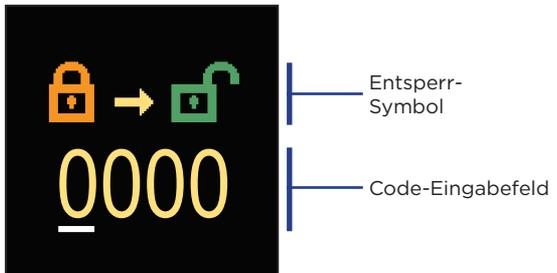
Mit den Tasten  $\ominus$  und  $\oplus$  können Sie den Wert ändern und mit der Taste  $\odot$  können Sie zur nächsten Position übergehen und das Entsperrern bestätigen. Verlassen Sie den Bildschirm mit der Taste  $\odot$ .
