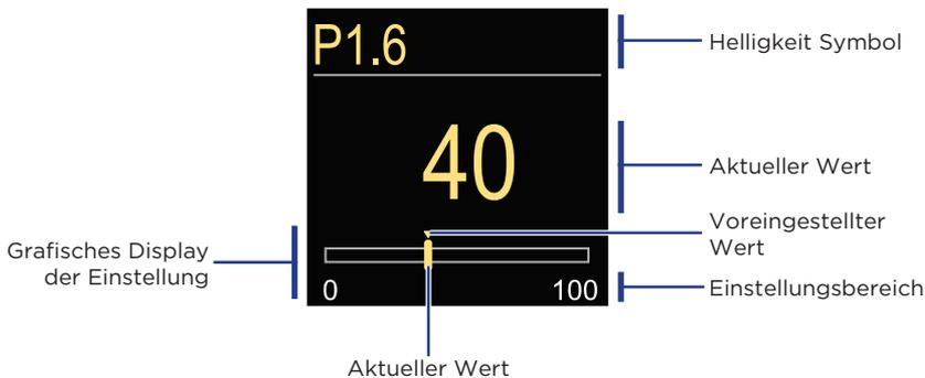
Verwenden Sie die Tasten  $\ominus$  und  $\oplus$ , um den angeforderten Wert einzustellen, und bestätigen Sie ihn mit der Taste  $\odot$ . Beenden Sie die Einstellung mit der  $\odot$  Taste.
