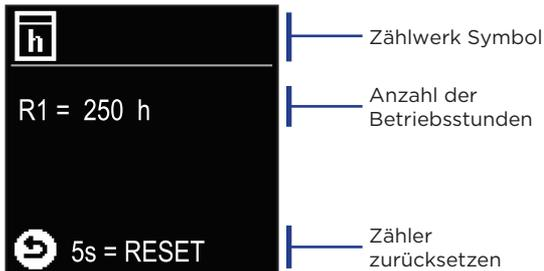
Durch 5 Sekunden langes Drücken der Taste
