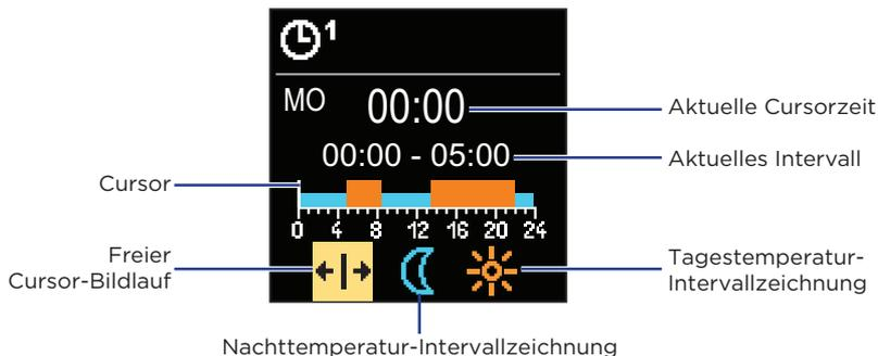
Wählen Sie mit der Taste  $\odot$  die gewünschte Ikone aus, um das Intervall zu scrollen oder zu zeichnen. Verwenden Sie dazu die Tasten  $\ominus$  und  $\oplus$ , um den gewünschten Verlauf des Zeitintervalls zu zeichnen.
