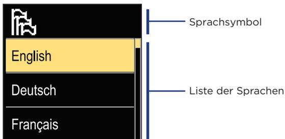
Verwenden Sie die Tasten  $\ominus$  und  $\oplus$ , um die Sprache auszuwählen, und bestätigen Sie sie mit der  $\odot$  Taste. Die Einstellung verlässt man mit dem Drücken der Taste  $\odot$ .
