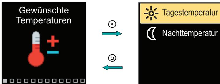
Navigieren Sie mit den Tasten  $\ominus$  und  $\oplus$  durch das Menü und bestätigen Sie Ihre Auswahl mit der Taste  $\odot$ . Ein neuer Bildschirm mit Temperaturen wird geöffnet.
