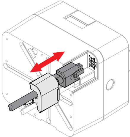
Im Fall einer Beschädigung des Netzkabels, kann es ersetzt werden. Das Kabel ist mit dem Netzstecker und Anschluss Stecker ausgerüstet. Um das Kabel auszutauschen, muss vorher der Kabelschutzdeckel entfernt werden.
