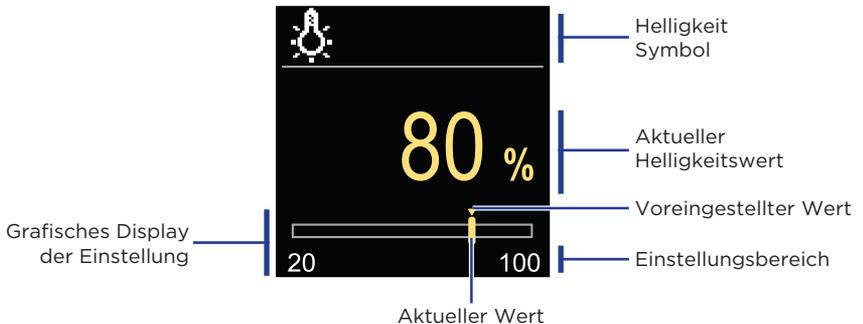
Verwenden Sie die Tasten  $\ominus$  und  $\oplus$ , um die Helligkeit anzupassen, und bestätigen Sie sie mit der Taste  $\odot$ . Beenden Sie die Einstellung mit der  $\odot$  Taste.
