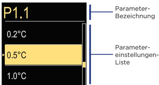
Verwenden Sie die Tasten  $\ominus$  und  $\oplus$ , um die gewünschte Einstellung auszuwählen, und bestätigen Sie sie mit der  $\odot$  Taste. Beenden Sie die Einstellung mit der  $\odot$  Taste.
