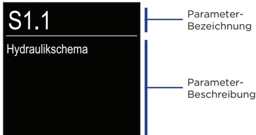
Navigieren Sie mit den Tasten ⊖ und ⊕ durch die Parameter in der ausgewählten Gruppe. Der Parameter, den Sie ändern möchten, wird durch Drücken der ⊕ Taste ausgewählt. Der Parametereinstellungsbildschirm wird geöffnet.
