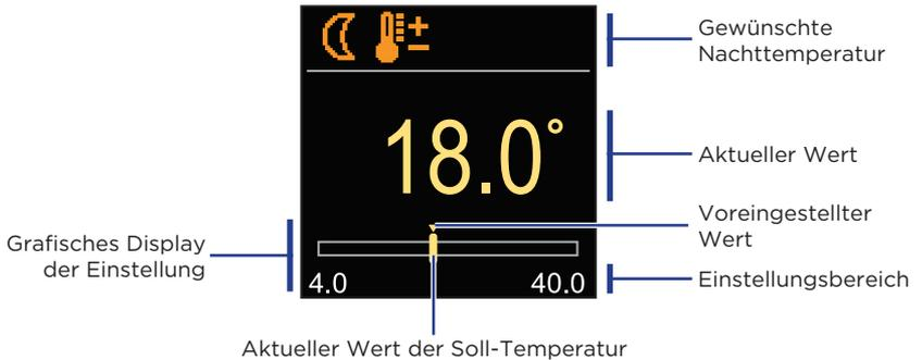
Verwenden Sie die Tasten  $\ominus$  und  $\oplus$ , um die Soll-Temperatur auszuwählen, und bestätigen sie mit der Taste  $\odot$ . Beenden Sie die Einstellung mit der  $\odot$  Taste.
