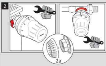
Klemmanschluss / Clamping connection
