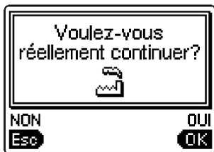
La régulation demande de confirmer le réglage de la courbe de chauffage avec la touche **OK**.
