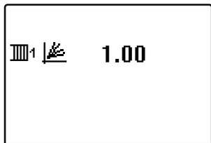
Réglez la pente de la courbe de chauffage pour le premier circuit de chauffage. Modifiez la valeur à l'aide des touches **←** et **→**.
