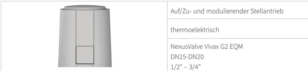
Die Stellmechanik des thermoelektrischen Antriebs arbeitet mit einem PTC-beheizten Dehnstoffelement und einer Druckfeder. Das Dehnstoffelement wird durch Anlegen der Betriebsspannung beheizt und der integrierte Stößel dadurch bewegt. Die durch die Bewegung entstehende Kraft wird auf den Ventilstößel übertragen und öffnet bzw. schließt somit das NexusValve Vivax G2 EQM.
