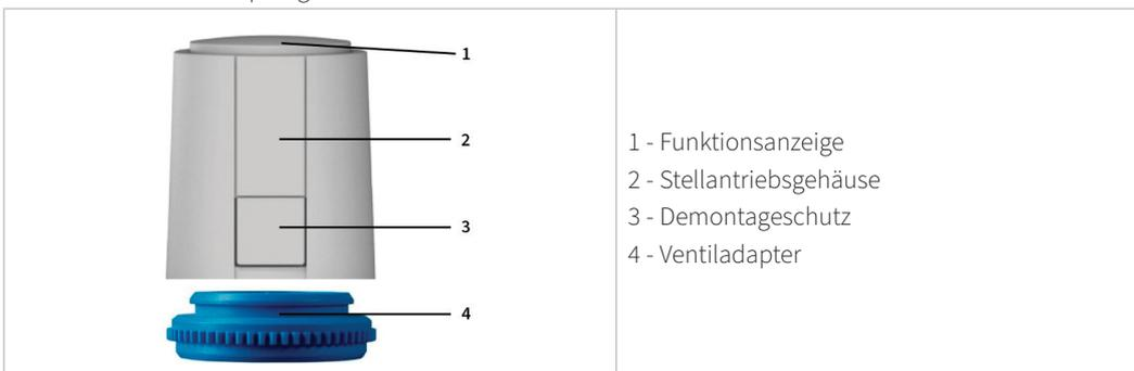
Die Funktionsanzeige dient zur Prüfung der Ventilposition. Wenn das eingebaute Wachselement sich ausdehnt bzw. zusammenzieht, bewegt sich die Funktionsanzeige entsprechend auf- bzw. abwärts.
