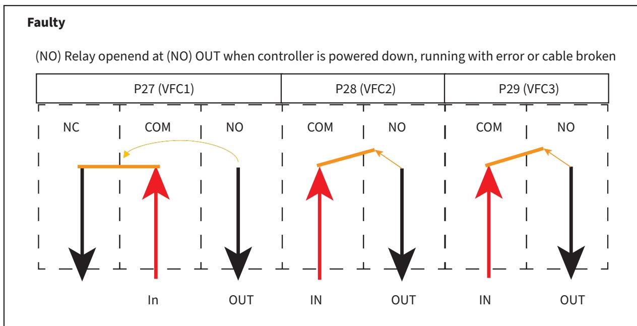
Az automata állapotának érzékelése. minden kimenethez egyéni hiba társítható.
